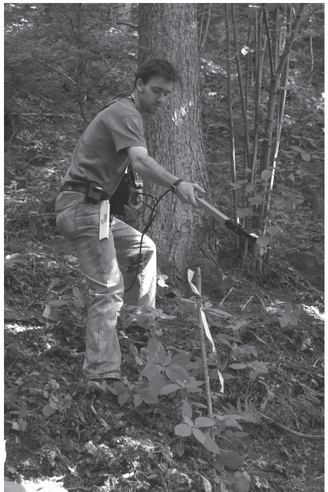
Abb. 4: Der Li-Cor LAI 2000 im Einsatz in den Leitewäldern des unteren Illz-Tales.
